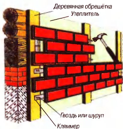
«Сухой» метод монтажа.
