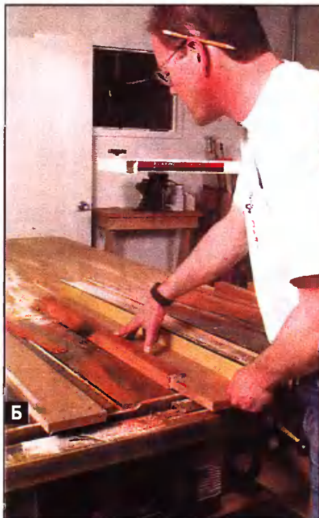
Фото 1. Зауживание ножек. А — приспособление для зауживания ножек состоит из двух полос ДВП одинаковой ширины. Б — два первых продольных запила в приспособлении. В — цветная маркировка поможет избежать ошибок.
