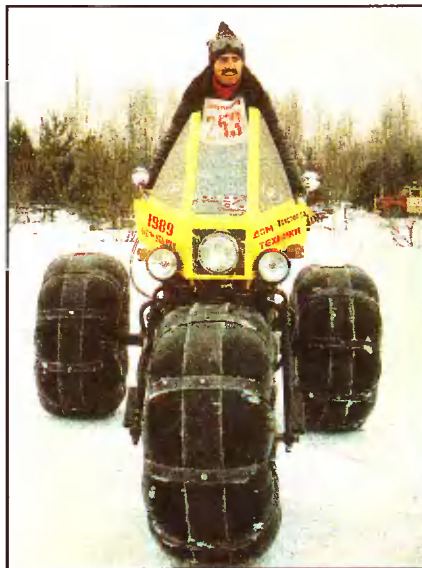
Вездеход на шинах низкого давления. За рулем — его конструктор О. Толстов из пос. Дорожный Марийской АССР.
