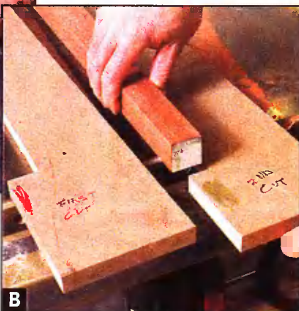
Фото 1. Зауживание ножек. А — приспособление для зауживания ножек состоит из двух полос ДВП одинаковой ширины. Б — два первых продольных запила в приспособлении. В — цветная маркировка поможет избежать ошибок.
